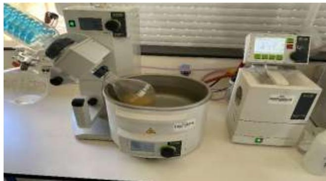
**Figure 19** : Récupération des extraits liquide de chaque échantillon par l'appareille de Rota vapeur
