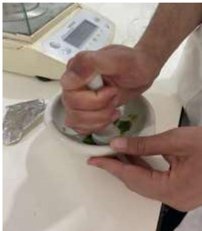
**Figure 16 :** Broyage des échantillons des raquettes de figue de barbarie et la gomme de pin
